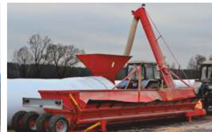
Использование БНП-12 «Ковчег» для подачи зерна в ЗПМ-180
