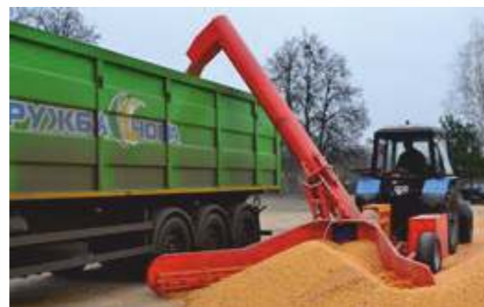
Перегрузка зерна в зерновоз с помощью НРУ-180
