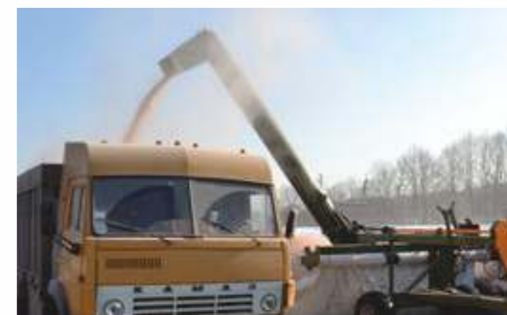
Зернораспаковочная машина ЗПМ-180 new в работе
